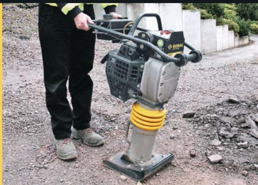
Vibrační pěchy BOMAG s benzínovými motory Honda GXR 120 (BT 60 a BT 65) je možné nasadit i v hlubších příkopech, než je výška člověka, širokých minimálně 1,5 m, a jsou uvedena na seznamu finanční podpory německého profesního sdružení stavebního průmyslu BG BAU: [www.bgbau.de](http://www.bgbau.de) (BG Bau, Německo, 2015)
